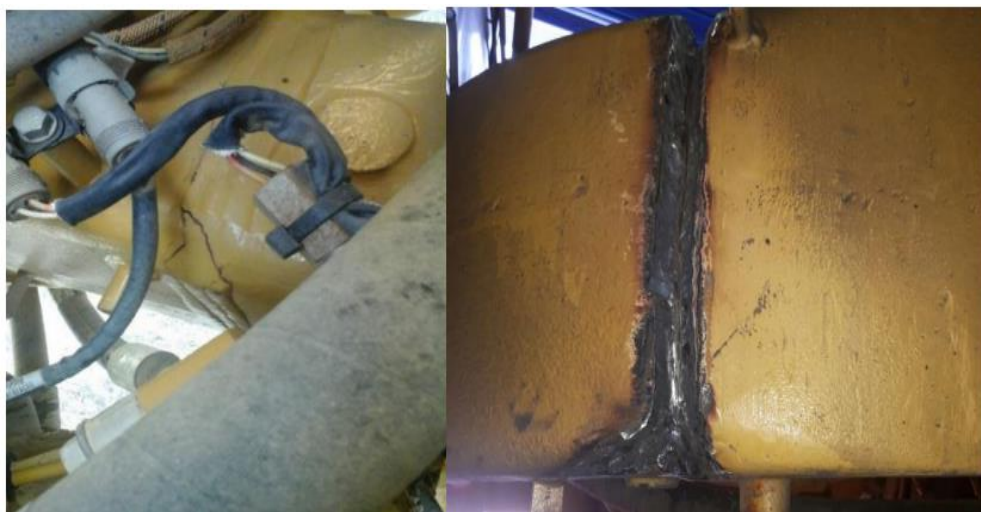
3.2 сурет - Дәнекерлеуден кейінгі рама жарығы
