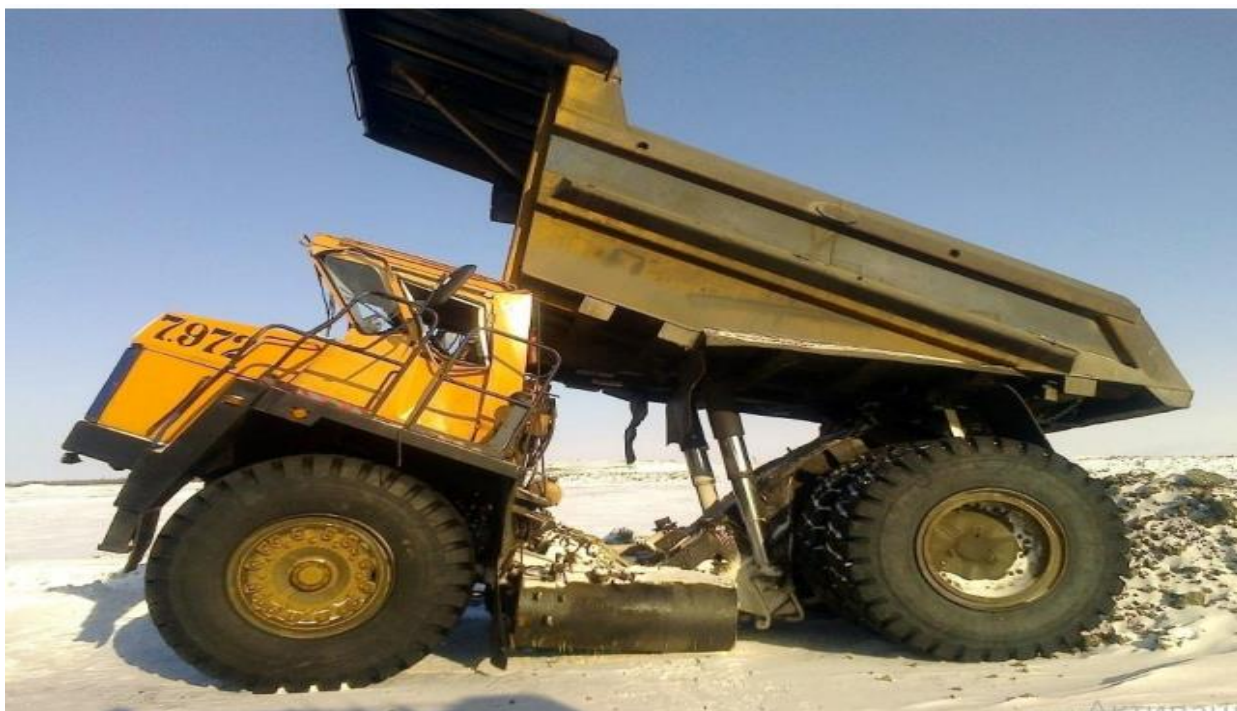
3.1 сурет - Раманың бойлық тіреулерінің бұзылуының салдары
